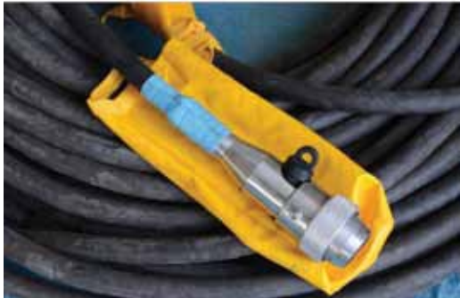
شکل ۵: کابل عملیات بای پاس
