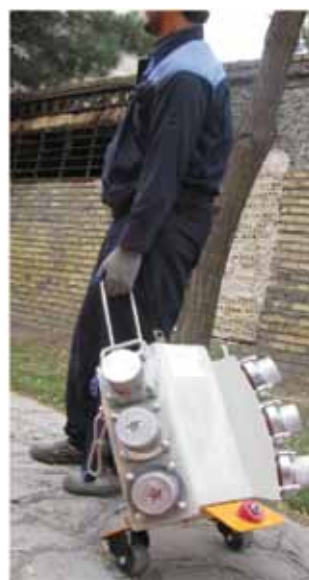
شکل ۷: کلید چمدانی ۲۰ کیلوولت قابل حمل
